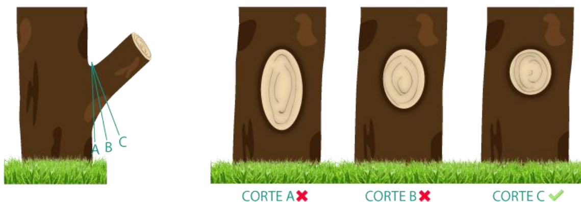
Figura 22 - Posicionamento correto do corte, para se obter uma seção circular (corte C).
